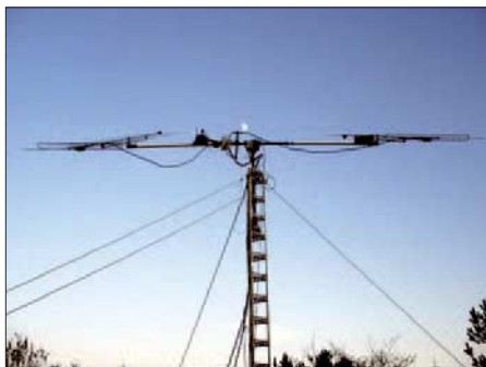
Den Mond im Fokus: Zwei 13-Element-Yagis bei OZ1ALS waren für EME mehr als ausreichend. Foto: OZ1LPR
