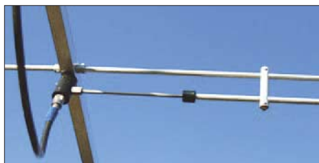
Bild 2: Gamma-Anpassung mit SO239-Buchse für hohe Leistungen
