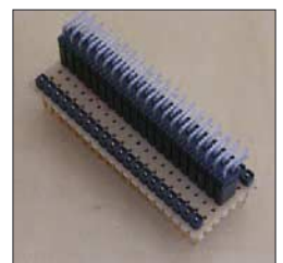
Bild 4: Die gewinkelte Stiftleiste auf einer Universalplatine dient als Adapter für Steckbrettaufbauten. Fotos: OE1RIB
