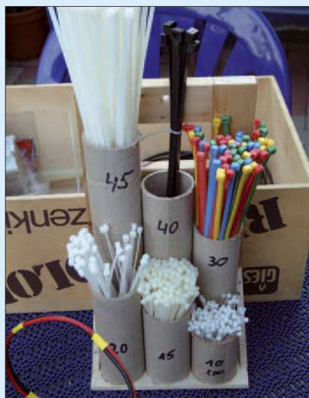
Bild 3: Wichtiges Arbeitsmittel: Kabelbinderbox; zur Aufbewahrung dienen einzelne Stücke 40-mm-HT-Rohr aus dem Baumarkt, das sich auch als Spulenkörper eignet.
