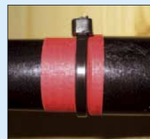
Bild 2: Sicherung der Elemente einer Angelrute mit Isolierband und Kabelbinder Fotos: DC1DV
