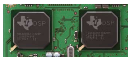
Bild 4: Mit Relais geschaltete Suboktav-Eingangsfiler für den KW-Bereich (links) Bild 5: Zwei 32-Bit-DSPs übernehmen die gesamte Signalverarbeitung und die Ansteuerung des Spektromskops. Fotos: Werkfotos
