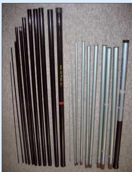
Bild 1: Für Vertikalantennen geeignete Angelruten im zerlegten Zustand: Links eine 12,5 m lange Angelrute [2] und rechts die 9,6 m erreichende Laser Fish aus dem Angelsport-Versand [1]
