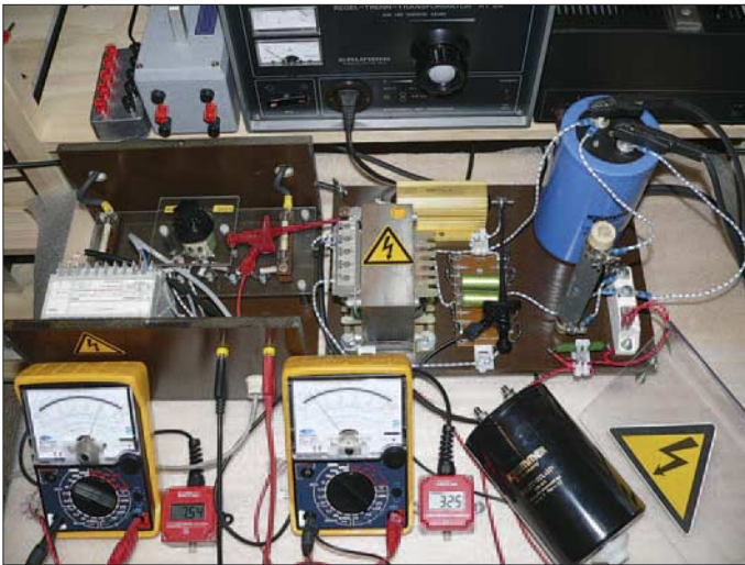
Bild 2: Schaltungsaufbau zum Formatieren der Kondensatoren; im linken Gehäuse befindet sich eine ältere Schaltung zur bezugspotenzialfreien Messung. Rechts die Formierschaltung, siehe Bild 5 oben. Zur besseren Einsicht wurden die Deckel abgenommen.
