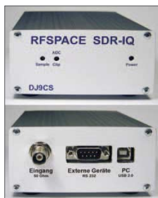
Bild 9: Ansicht des Standardgehäuses der Abmessungen 104 x 48 x 104 mm 3 mit der SDR-IQ-Platine. Das Seriengerät wird ein anderes Gehäuse besitzen.
