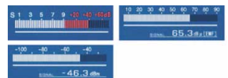
Bild 10: Die Anzeige der Signalstärke lässt sich umschalten: Bei dBm und dBµV sind die Messwerte sehr genau.
